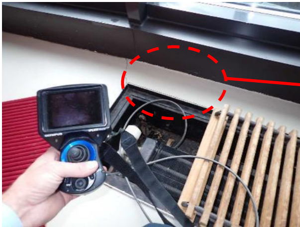
Afb 7. Aanzicht endoscopisch onderzoek onder de pui.
