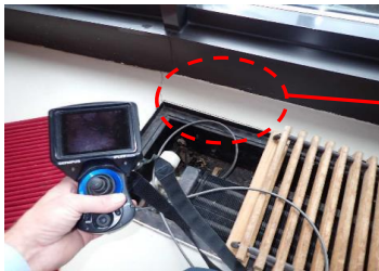
Afb 7. Aanzicht endoscopisch onderzoek onder de pui.
