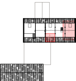
2E VERDIEPING | BESTANDE SITUATIE | SLOOF | 1:200
